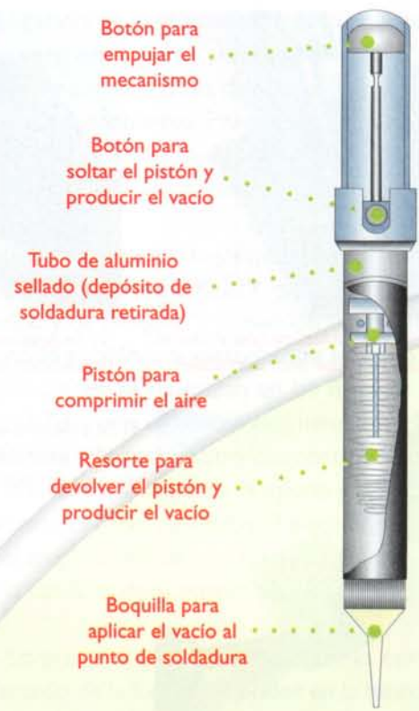
Figura 12.18. Estructura interna de un desoldador mecánico
